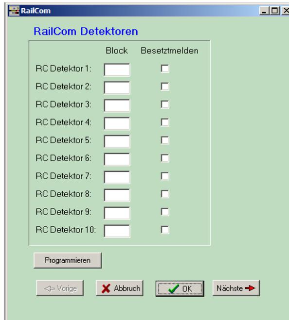
Diese Taste öffnet ein Fenster, in das die zu programmierende Adresse eingegeben wird. Nach Einschalten der Anlage ein wird der Detektor in den Programmiermodus gesetzt, danach ist die OK-Taste zu drücken.
